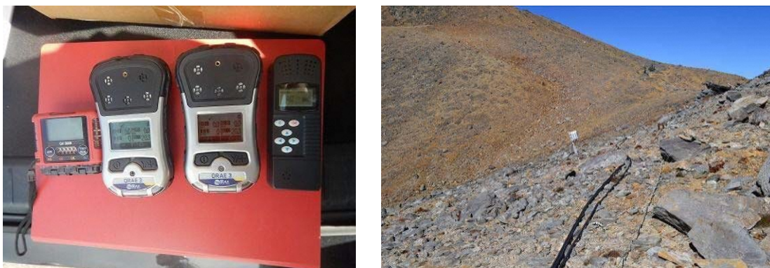
写真 5.3.1 ガス検知器 (左：携帯型ガス検知器、右：設置型ガス検知器 (御嶽山))
