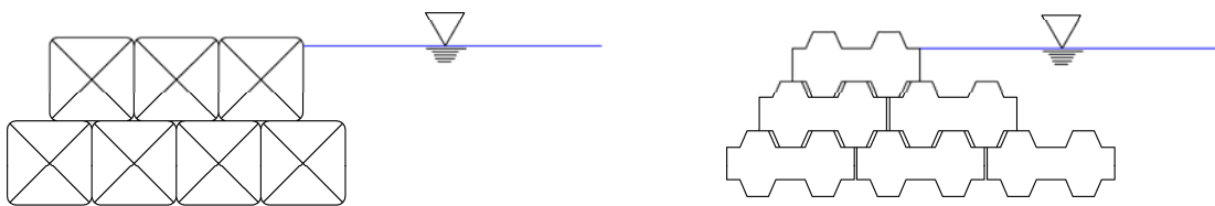
図 4.3.3 導流堤工のイメージ図 (左図：大型土のう、右図：コンクリートブロック)
